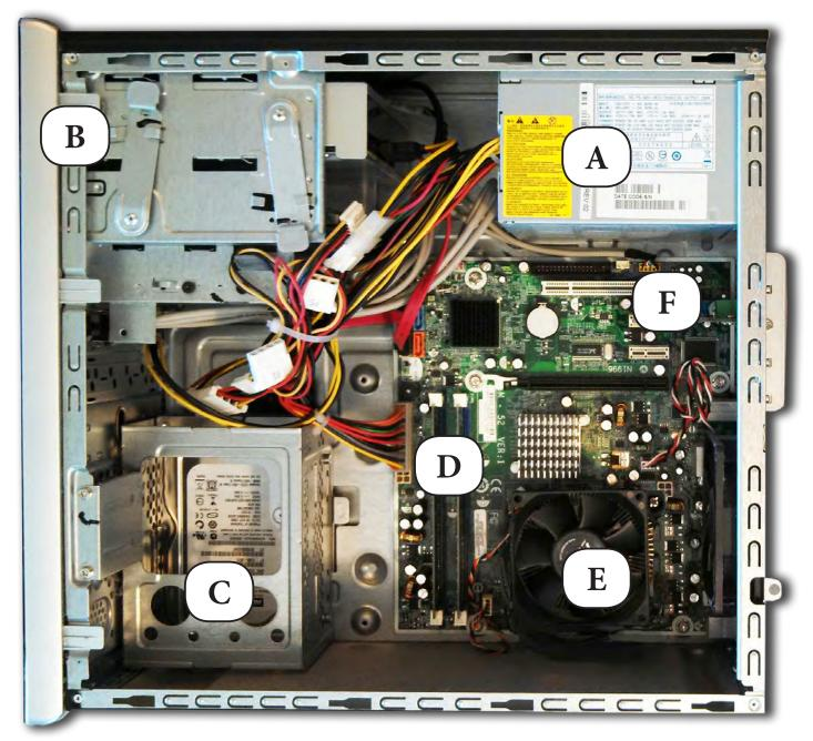
A) Power Supply B) Expansion Bays for CD/DVD, etc. C) Hard Drive
